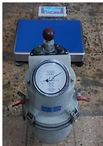
Figure II- 16. Évaluation de la quantité d'air occlus dans le béton à l'aide du manomètre.
