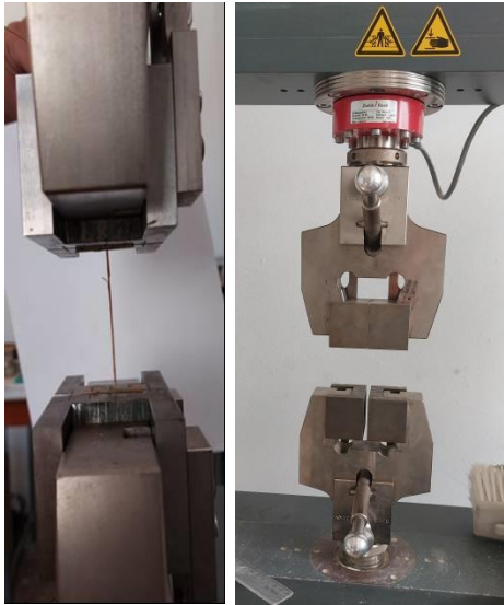
Figure II- 9. Dispositif de chargement utilisé pour l'essai de traction de fibres palmiers dattiers.
