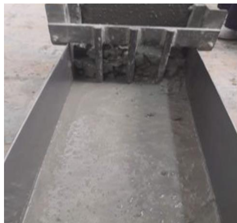
Figure III- 7. Blocage des granulats au niveau des barres de la boîte en L du BAP2 avec (G/S = 2 et Dmax = 16mm).
