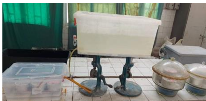
Figure II- 27. Dispositif de l'essai d'absorption d'eau capillaire.
