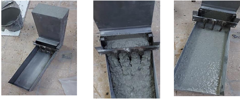
Figure II- 14. Essais du pouvoir de remplissage (la boîte en L).
