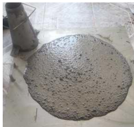
Figure I-2. Mesure de l'étalement pour un BAP.
