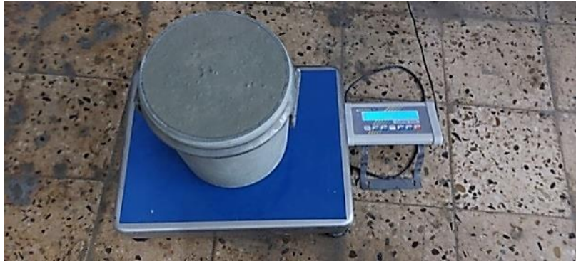
Figure II- 17. Mesure de la masse volumique réelle.
