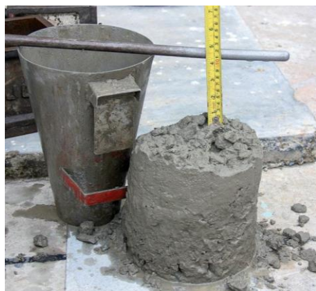
Figure I-1. Mesure de l'affaissement d'un béton ordinaire.
