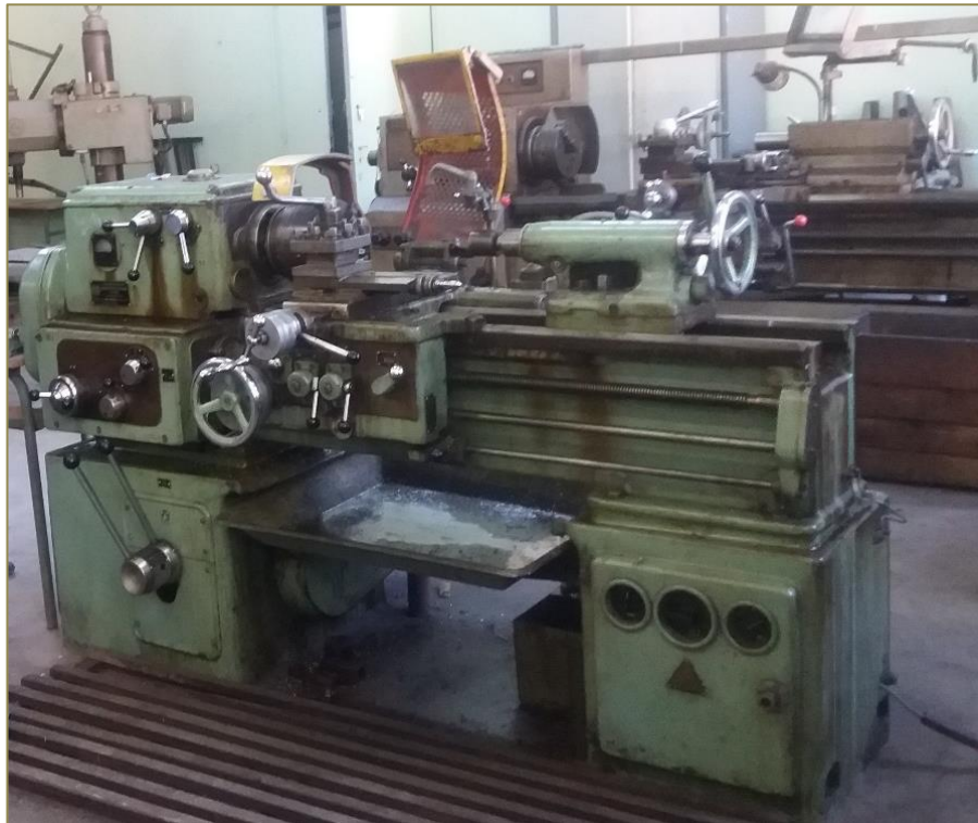
Figure II.10. Tour de brunissage (modèle 16k20).
