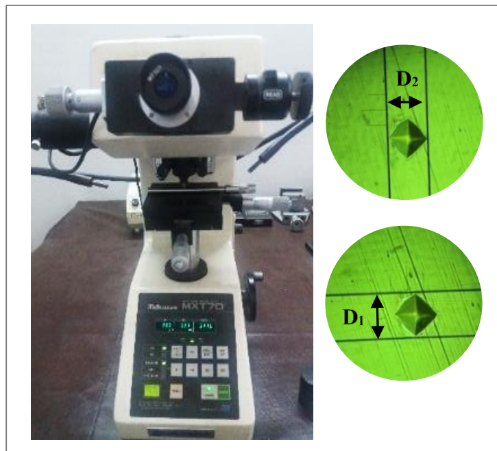
Figure II.6. Mesure de la dureté réalisées avec l'indenteur Matzuzawa MXT70.
