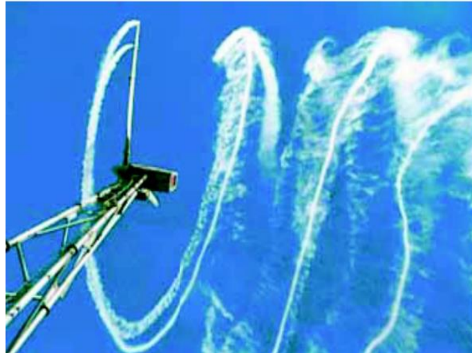
Figure III-3: Observation du Comportement du Sillage des Éoliennes à l'Aide de Fumée [ 84]
