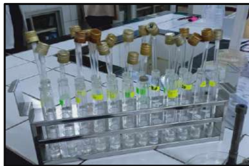
Figure 37: Préparation des suspensions bactériennes à partir de 21 souches
