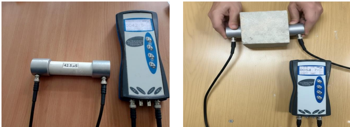
Figure 2.22. Procédure d'étalonnage et mesure de la vitesse ultrasonique à travers une éprouvette cubique de béton.
