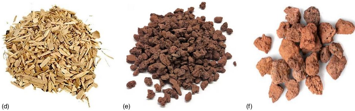
Figure 1.3. Quelques exemples de granulats légers naturels : (a) pierre ponce, (b) balle de riz, (c) diatomite, (d) sciure de bois, (e) Cendres volcaniques et (f) Scories.
