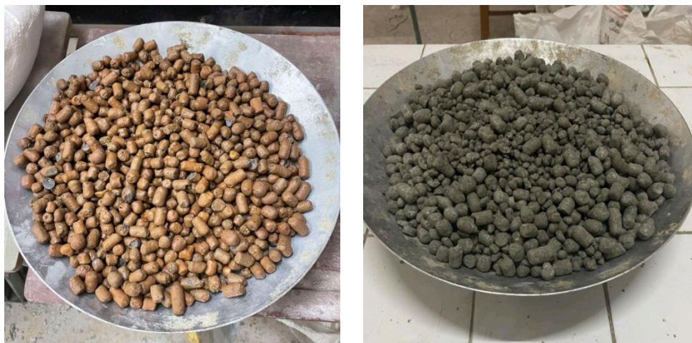
Figure 2.12. GLAE bruts (photo de gauche) et après enrobage avec une pâte de ciment (photo de droite).
