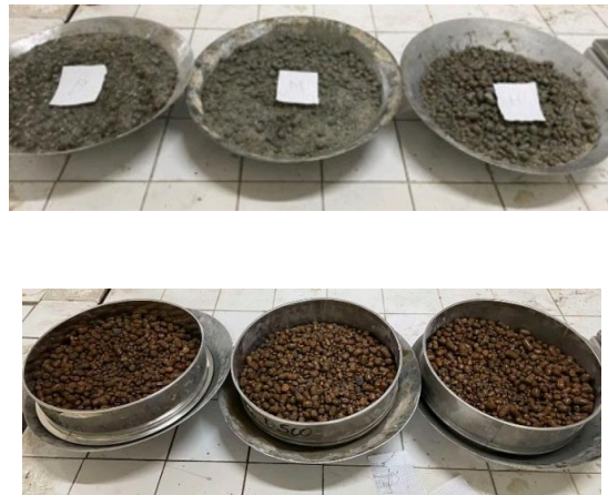
Figure 2.21. Récupération des GLAE par tamisage après lavage du BAPL, pour chaque section.
