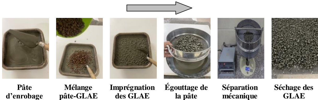
Figure 2.11. Récapitulatif des opérations d'enrobage des GLAE.
