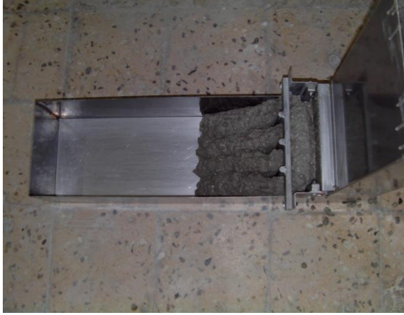
Figure 2.18. Observation de l'écoulement du béton dans l'essai à la boîte en L.
