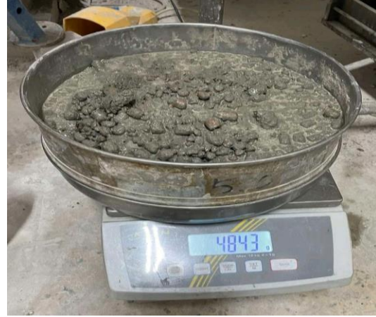
Figure 2.19. Mesure de la stabilité au tamis après deux minutes de repos du BAPL.
