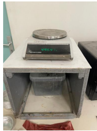
(a) Immersion des éprouvettes durant l'essai (b) Dispositif de la pesé hydrostatique
