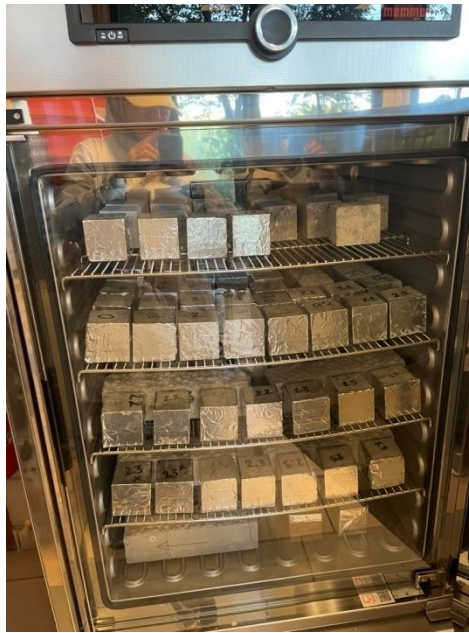
Figure 2.26. Vue de l'enceinte de carbonatation employée lors des essais de carbonatation accélérée.
