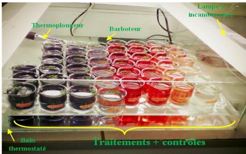
**Figure IV.3.** Schéma du protocole expérimental pour l'élaboration des essais de toxicité des colorants MC et ES avec *L.gibba*
