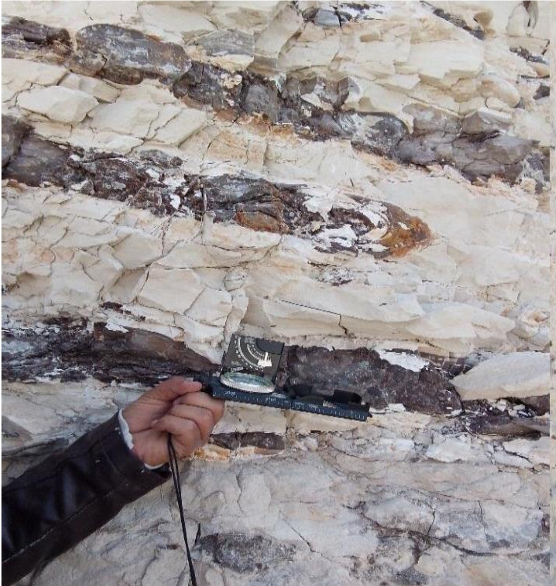
Fig.31 : Mesures d'orientation et de pendage des discontinuités in-situ.
