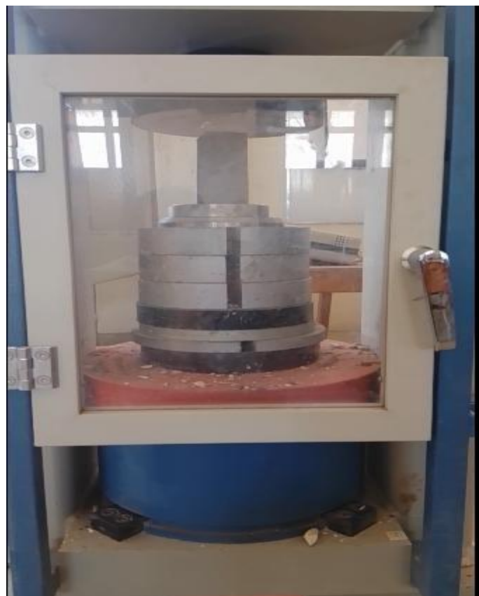
Fig. 29 : Écrasement des échantillons au laboratoire par presse hydraulique
