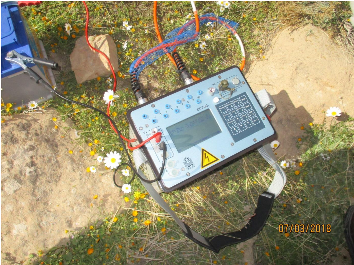
Fig.43 : Résistivimètre SYSCAL+ une batterie
