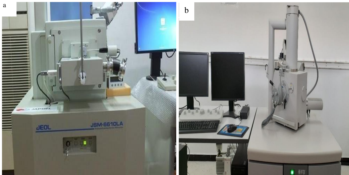
Figure III.6. MEB utilisé pour les essais métallographiques : a. JEOL JSM-6610LA, b. QUANTA 250.
