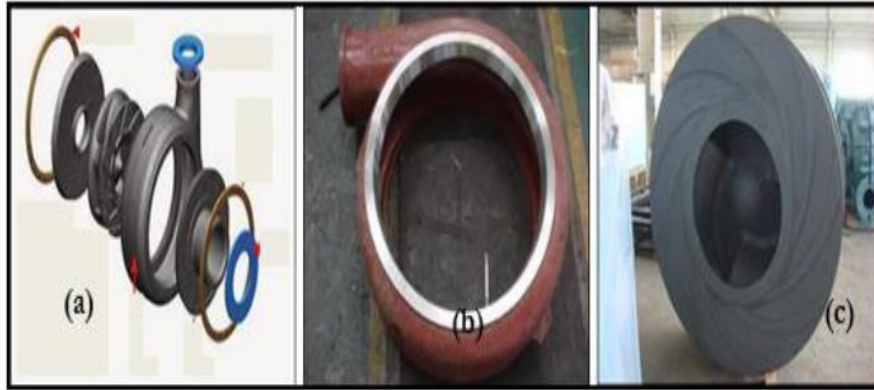
Figure II.2. Pièces de pompage de boues en fonte à haute teneur au chrome. [9].
