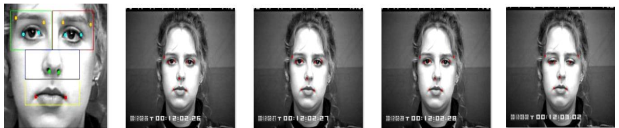
Figure 4-10 : Mauvais suivi associé à mauvaise détection par l'histogramme cumulatif.
