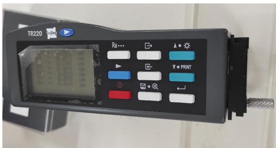
Figure II.9. Rugosimètre TR-220 utilisé pour la mesure de la rugosité des revêtements.
