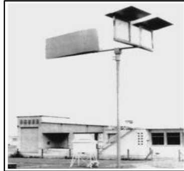
Figure 05 : Capteur de Hirst(1952).
