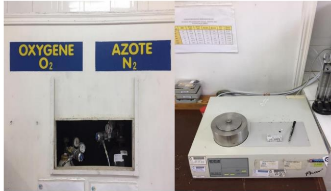
Figure III.7. Machine Calorimétrie Différentielle à Balayage (DSC).
