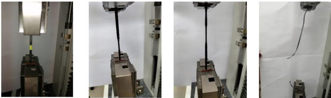
Figure IV.2. Série de vues de illustrant l'étirement d'une éprouvette filament.
