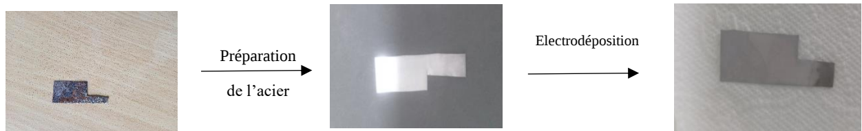
Figure.II.4. photo de la cathode avant et après le dépôt.
