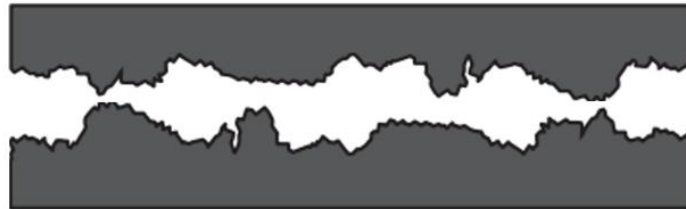
Figure 1.18. La rugosité de deux surface en contact à l'échelle microscopique.
