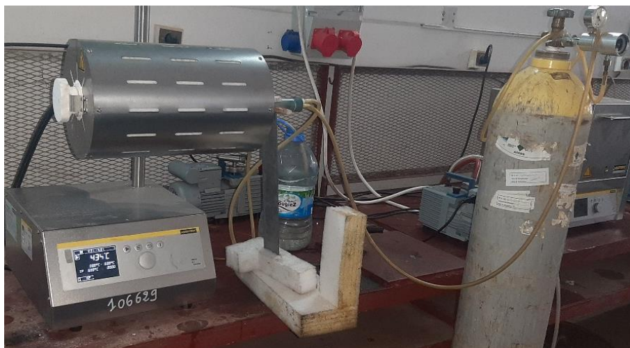
Figure 5.10. Le four de frittage utilisé avec l'installation de l'alimentation de l'argon
