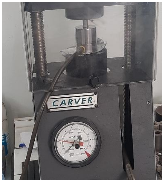
Figure 5.9. La machine de compactage utilisé.
