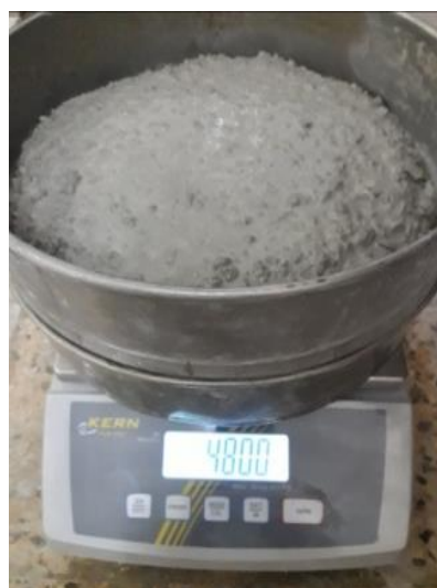
Figure 2.22. Béton en repos pour le calcul du pourcentage de laitance traversant le tamis (LMGE, Annaba)
