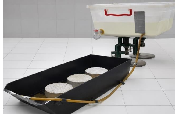
Figure 2.27. Mesure de l'absorption d'eau par capillarité (LMGE, Annaba)
