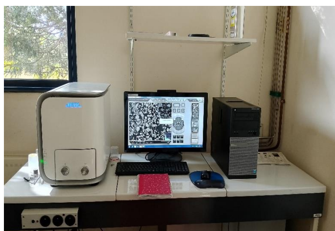
Figure 2.16. MEB JEOL utilisé pour les observations microstructurales (IMT Nord-Europe, Lille)
