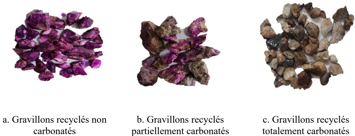
Figure 2.14: Evolution de l'état de carbonatation des gravillons recyclés
