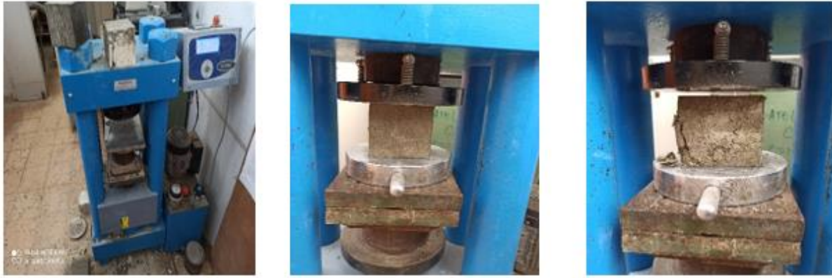
Figure 2.24. Mesure de la résistance en compression (LMGE, Annaba)
