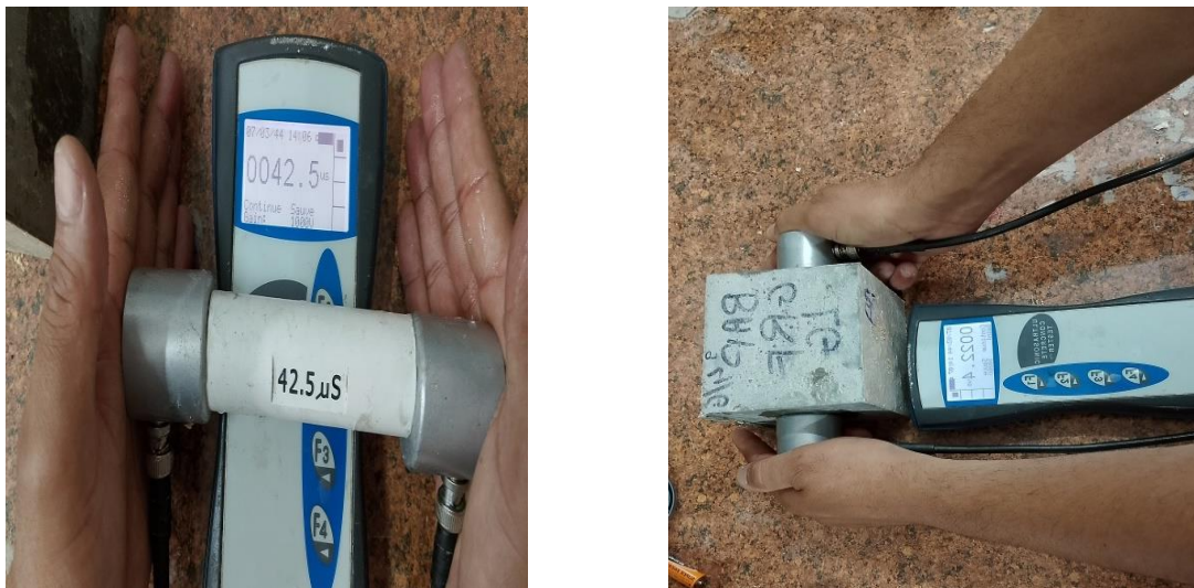
Figure 2.25. Mesure de la vitesse de propagation des ondes ultrasoniques (LMGE, Annaba)
