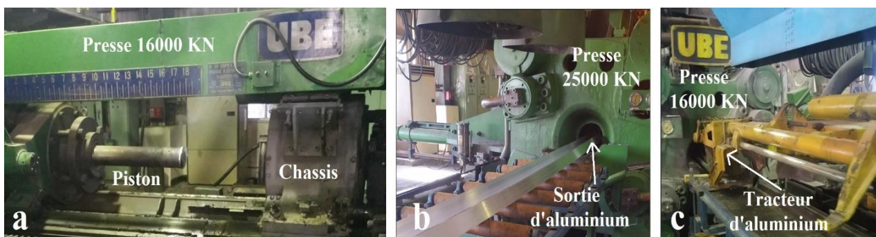
Figure.II.2 : Composantes des presses d'extrusion : a) Piston d'extrusion et Châssis de la Presse d'extrusion, b) Sortie de profilé d'aluminium extrudé du côté arrière de la presse et c) Dispositif tracteur des profilés d'aluminium extrudés dans la presse
