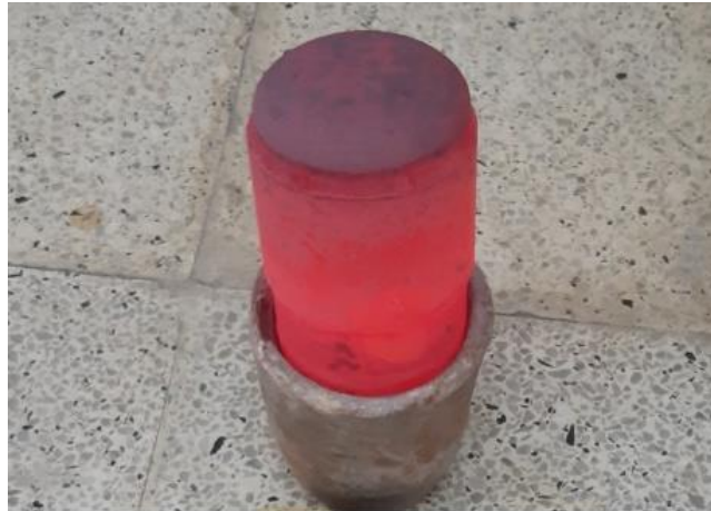
Figure.II.18 : Caisse de boruration (phase refroidissement à l'air) après traitement à 900°C pendant 6h.
