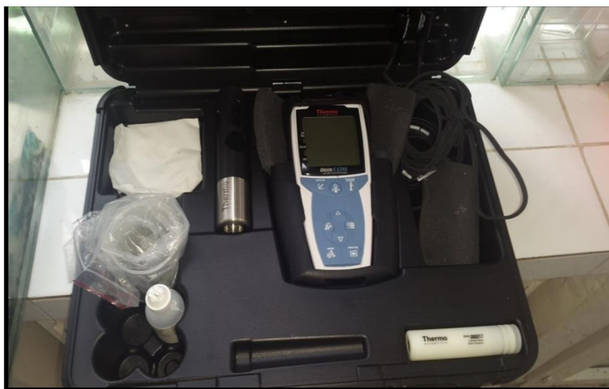
Figure 15. Multi-paramètre «Thermo scientific Orion 5-star multi-paramètre portable» (Rezzag Mahcene, 2019).
