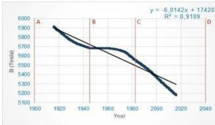
Figure 46: Diagrammes graphiques indiquant la relation entre le champ magnétique terrestre (B tesla) et l'année à New York pendant la période 1916-2016. Régression linéaire de B tesla par rapport à l'année de la forme y = ax + b (ligne noire), où B (Tesla) est la
