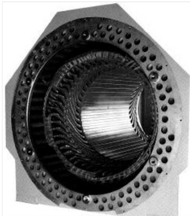
Fig. 2.1 Stator d'une machine synchrone de forte puissance
