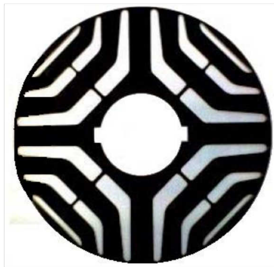
Fig. 2.12 Coupe transversale d'un rotor de MSR à barrières de flux [43]
