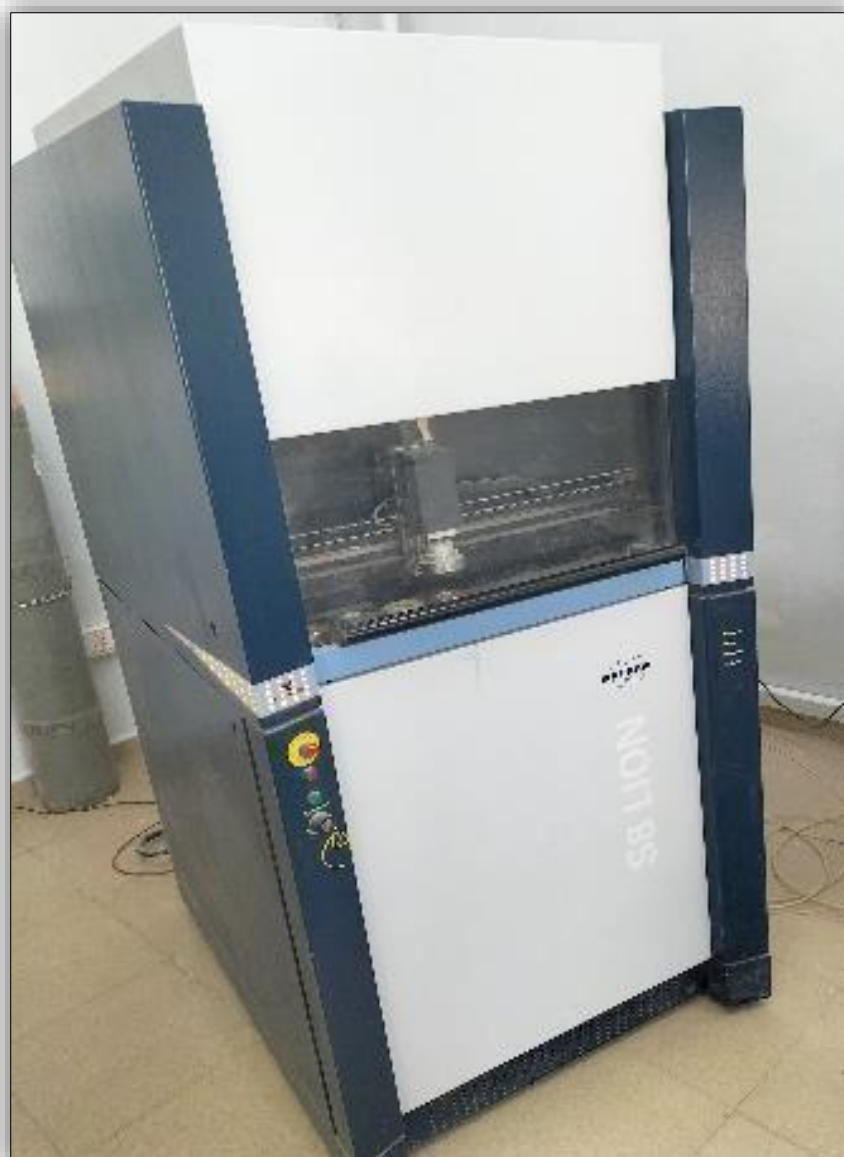
Figure 47- Spectromètre de fluorescence S8 LION, machine à rayons X dispersifs Bruker AXS, Allemagne
