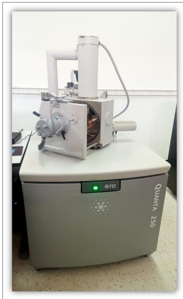
Figure 48- Microscope électronique à balayage PHILIPS / FEI model QUANTA 250
