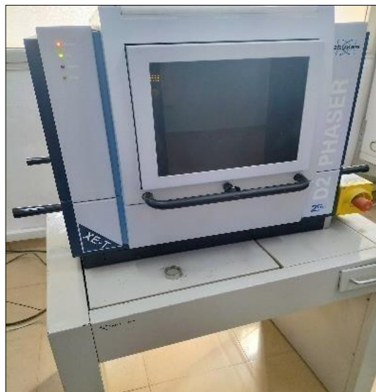
Figure 46 - Diffractomètre à rayons X de paillasse type BRUKER D2 PHASER
