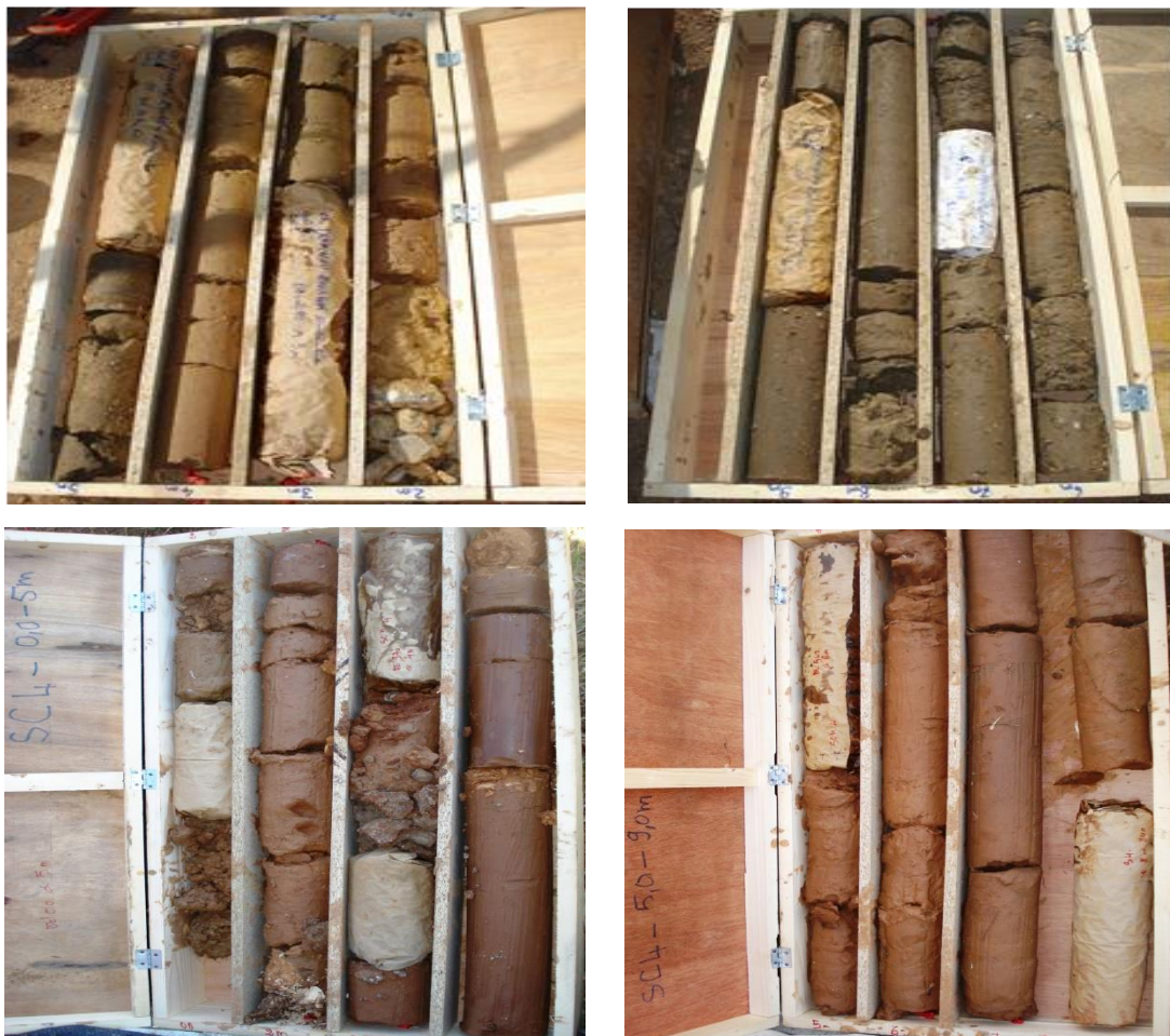
Figure III.9. Échantillons du sol par carottage du projet tramway Constantine [111].
