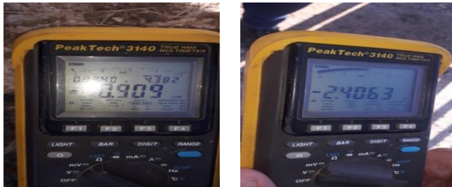
Figure III.7. Valeurs du potentiel avant et après le passage du tramway.
