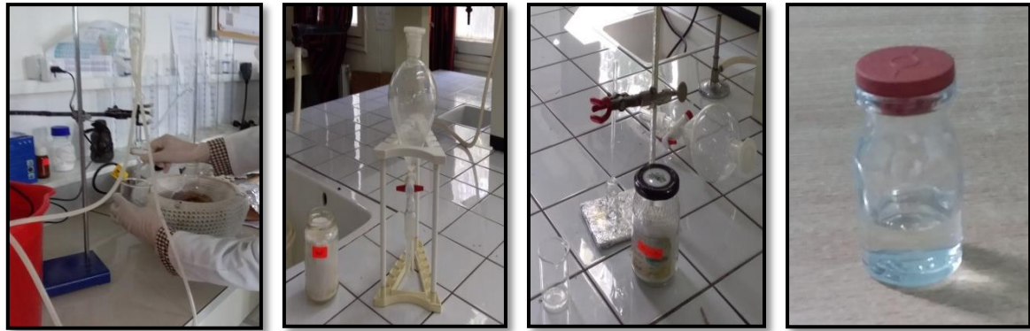
Figure 39: Extraction des huiles essentielles des feuilles de D. innoxia Mill par un hydrodistillateur de type Clevenger (Photos Personnelles).
