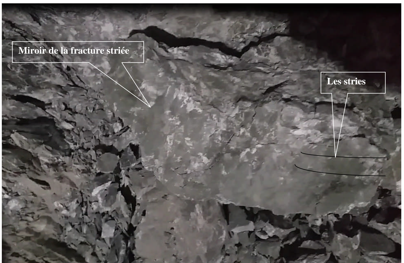
Figure V.22 : les stries dans les surfaces de fractures des argilites
