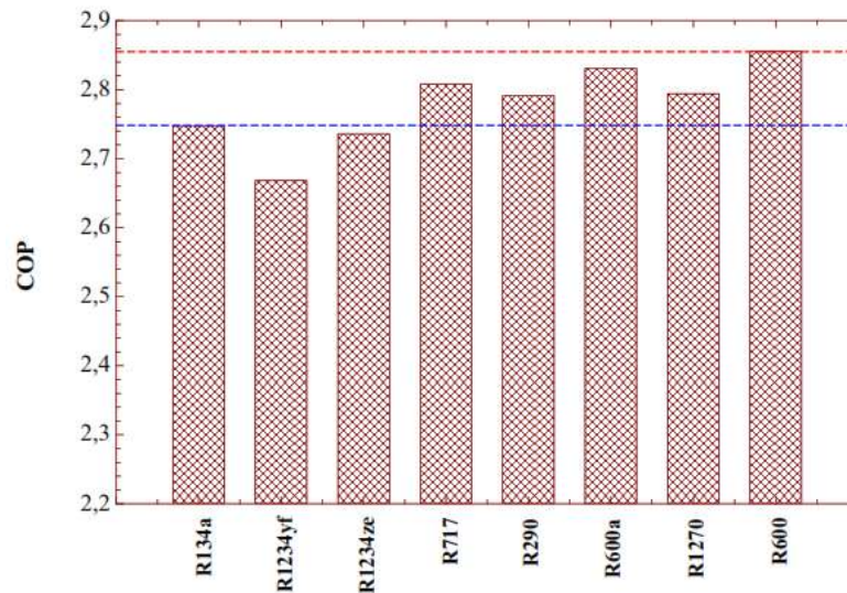
Figure 4.3: Effet de la nature du fluide sur le coefficient de performance du système conventionnel à compression de vapeur avec deux évaporateurs
