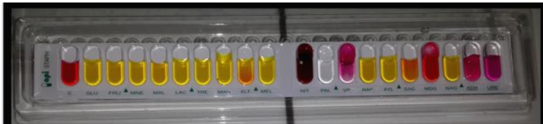
Figure 24 : Illustration du profil biochimique d'une souche S.aureus identifiée par système API STAPH.
