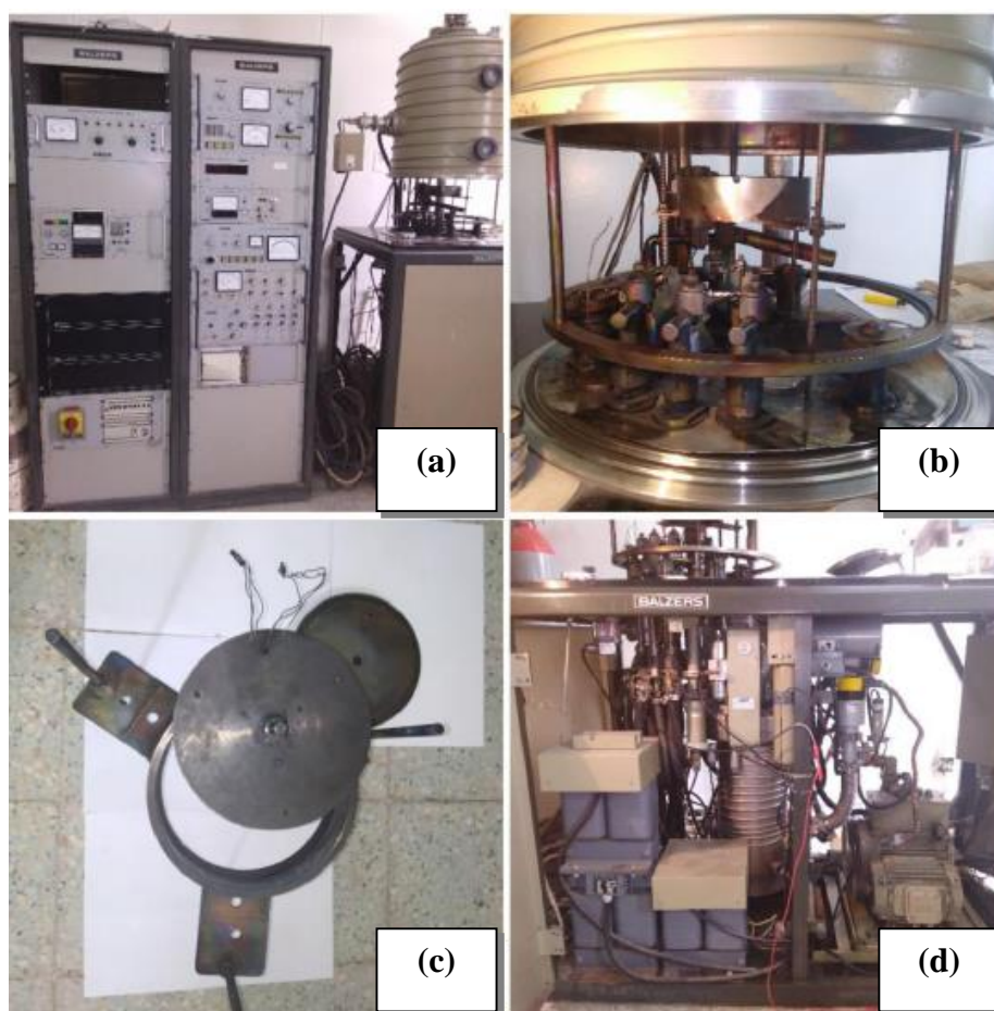
Figure II.9 : Bâti d'évaporation ((a, d) Système de pompage, (b) Une enceinte à vide, (c) Port substrat).
