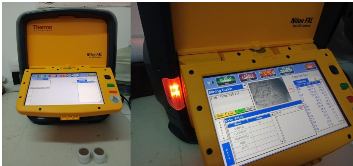
Figure 43. Spectromètre « NITON FXL FM-XRF analyser » à balayage au rayon X
