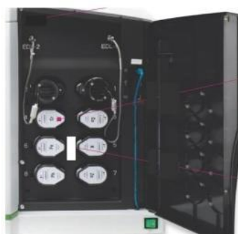
Figure 39 a. Emplacement des lampes dans PinAAcle_900T
