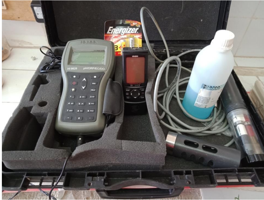
Figure 38. Le multi-paramètre utilisé (Hanna instrument 9828)
