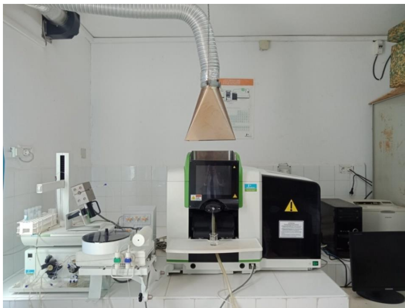
Figure 39. Spectromètre d'absorption atomique type Perkin Elmer, marque PinAAcle900T
