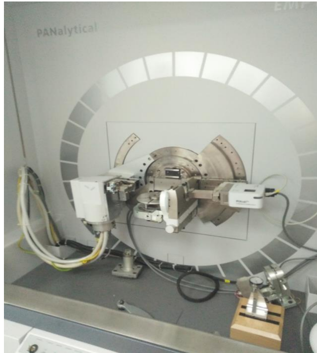
Figure II-13 : Diffractomètre de type PANALYTICAL Empyrean.
