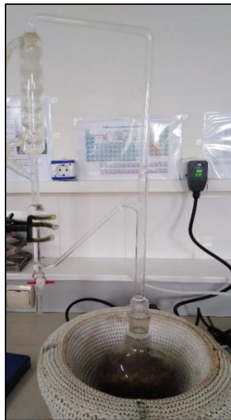
Figure 6. Extraction par hydrodistillation à l'aide d'un appareil Clevenger (photo personnelle, 2023).
