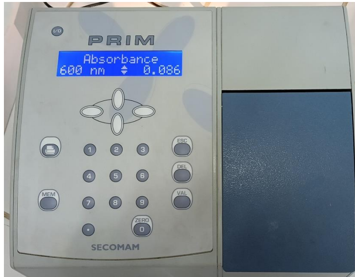
Figure 47. Mesure de l'absorbance à l'aide d'un spectrophotomètre (photo personnelle, 2024).
