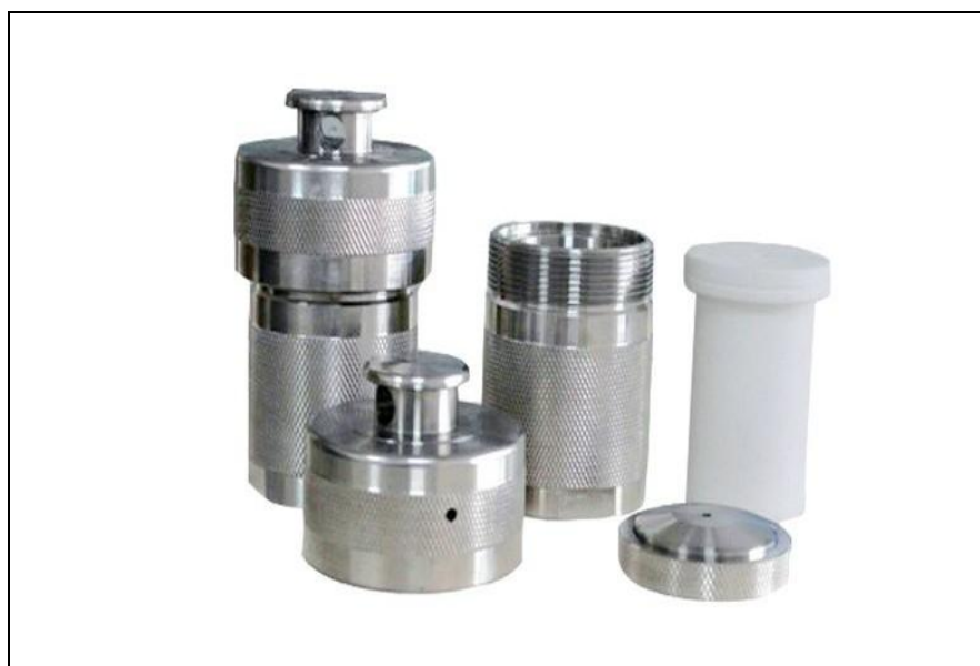
Figure II. 1 : Autoclave utilisé dans le procédé hydrothermal.
