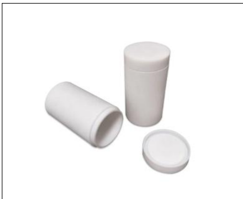
Figure II. 2 : Tube en téflon d'un réacteur pour la synthèse hydrothermale.
