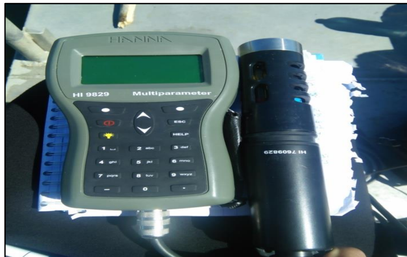
Figure 11. Multi paramètre de terrain (HANNA HI 9829).
