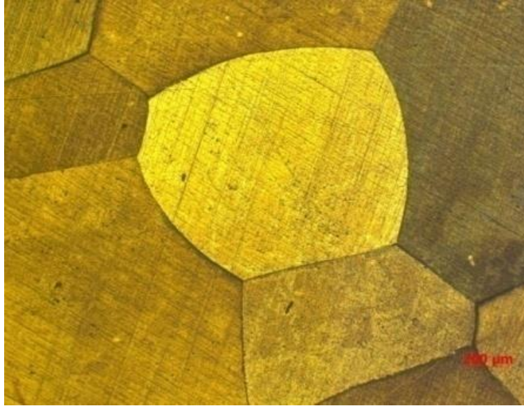
Figure IV. 11 : Microscope optique de l'échantillon CuZnAl 3 après une homogénéisation pendant 15 min à 850°C (état austénitique)[35].
