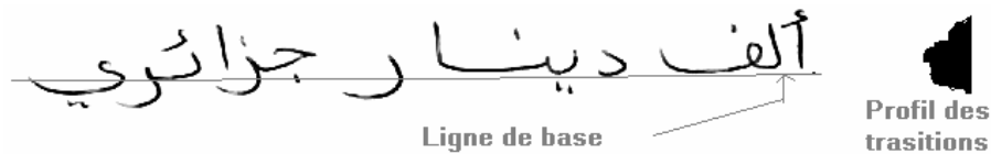
Figure 4.1 : Exemple d'un profil des transitions.
