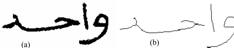
Fig 2.7 : Squelette d'un mot binaire :(a) Image binaire du mot (واحد), (b) Squelette de (a).
