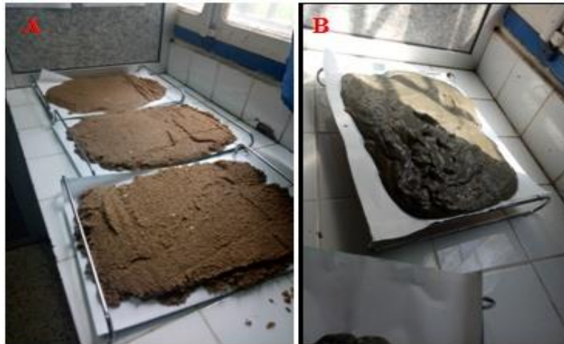
Figure 22. Echantillons de sédiment avant séchage A- sédiment de la plage Lahnaya B- sédiment du port d'Annaba (cliché : Laouati, 2017).
