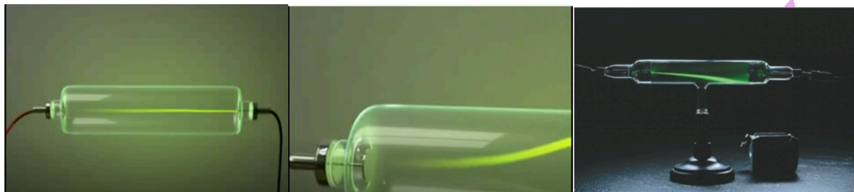
Figure II.3. Expérience de JJ Thomson Déviation du rayon cathodique sous l'effet d'un champ magnétique ou électrique.
