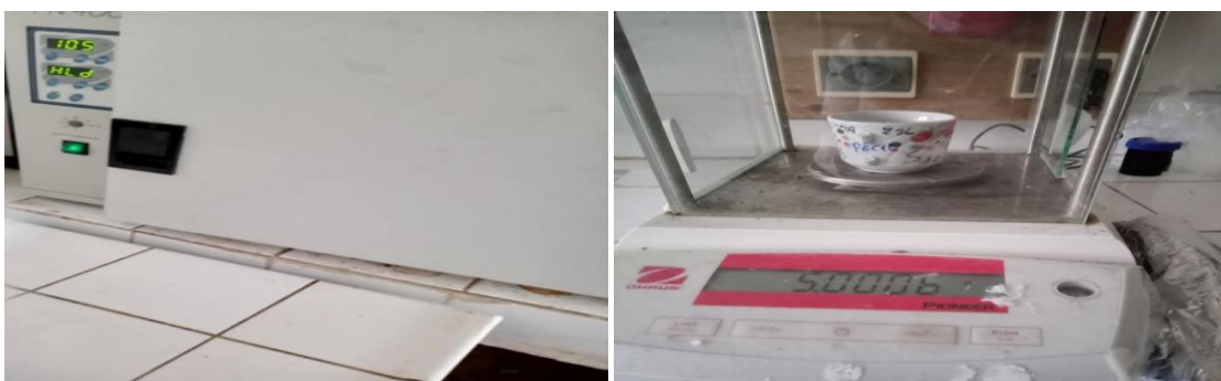
Figure 15 : Matériel utilisé pour la détermination de l'humidité hygroscopique du sol. © Dahmani C. (2021).
