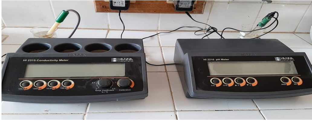
Figure 14 : Instrument utiliser : pH mètre et conductimètre (Hanna Instrument, The Netherlands). © (Dahmani C., 2021).
