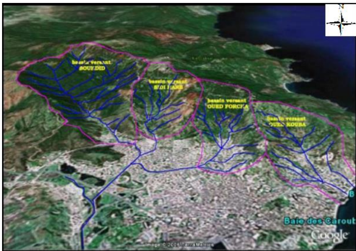
Figure (08) : Bassin versant et réseau hydrographique de la ville d'Annaba, image en 3D, Tracé sur image « Google Earth ».
