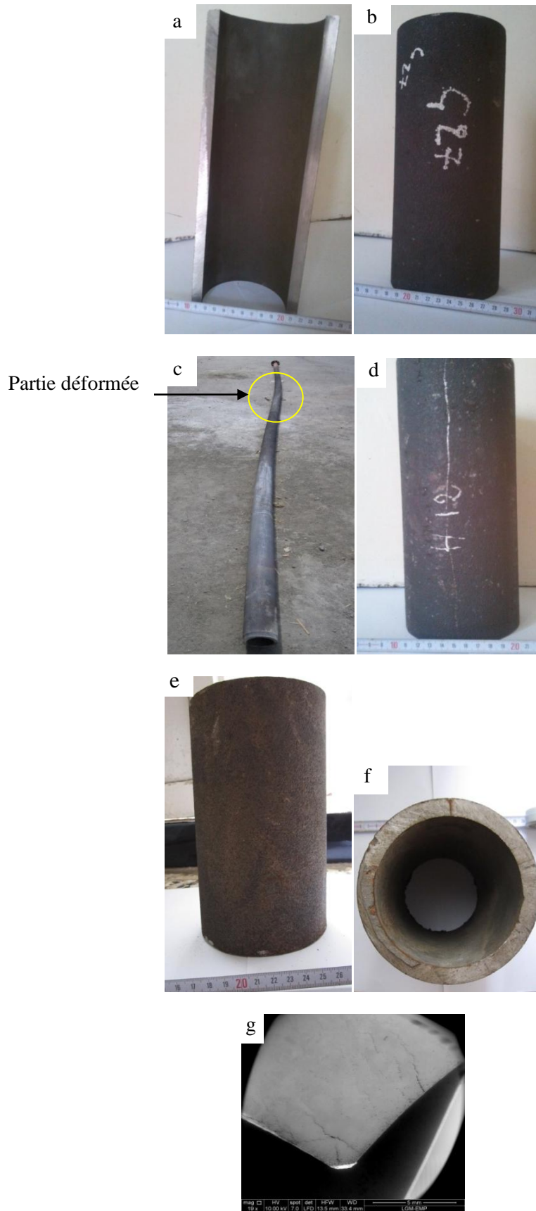
Figure III.1. Observations macrographiques des tubes ayant déjà servis après : 5760h (a-b), 8640h (c-d), 60480h non endommagés (e-f) et g. 60480h endommagé
