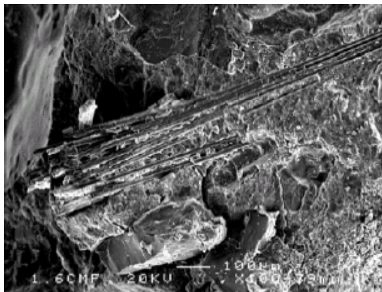
Fig. III-36: Photo prise au MEB montrant les fibres qui sont restées en faisceaux
