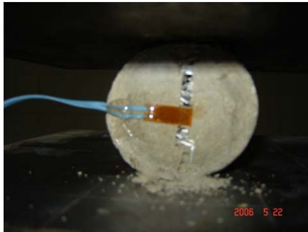
Fig. III-13: Mode de rupture en traction par fendage
