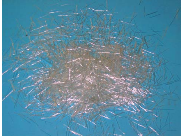
Fig II-2 : Fibre de verre utilisée de type Cemfil (A.R).
