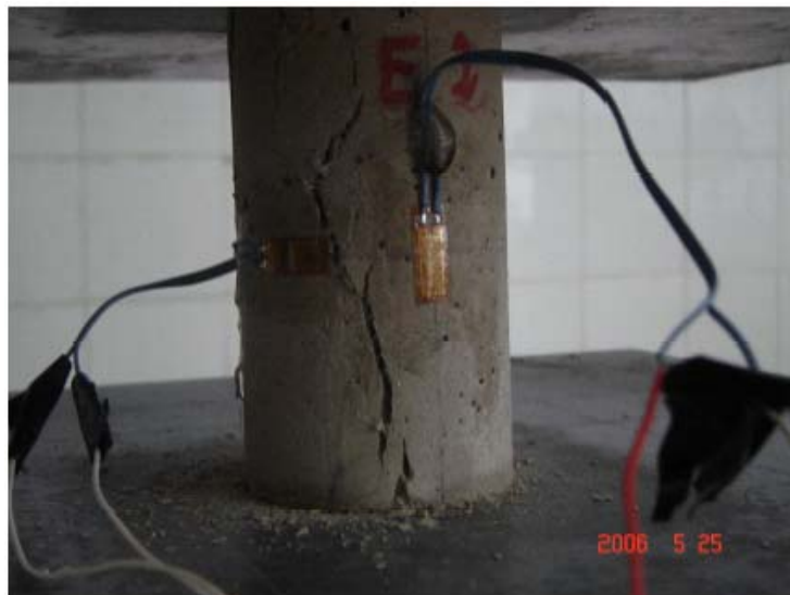
Fig. III-11 : Mode de rupture en compression de l'échantillon cylindrique
