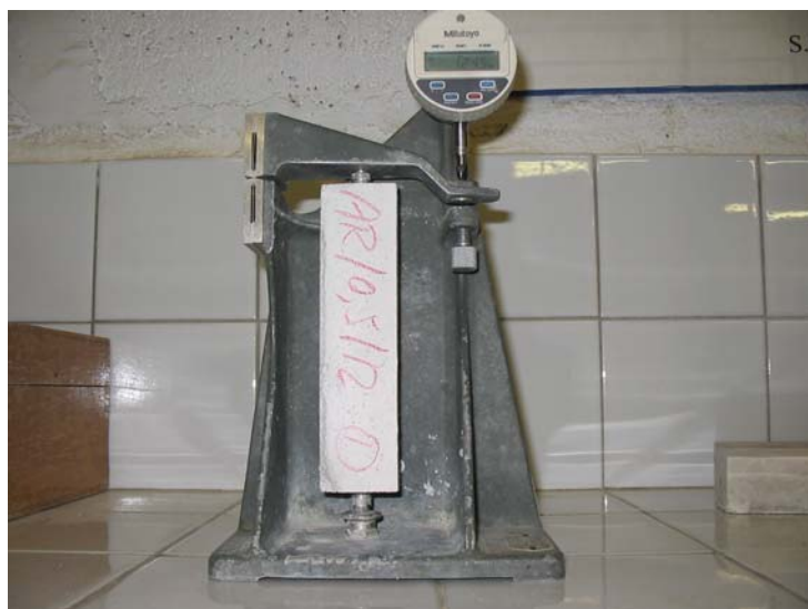
Fig II-5 : Dispositif de mesure de la variation dimensionnelle pour éprouvette 4x4x16 cm 3 .
