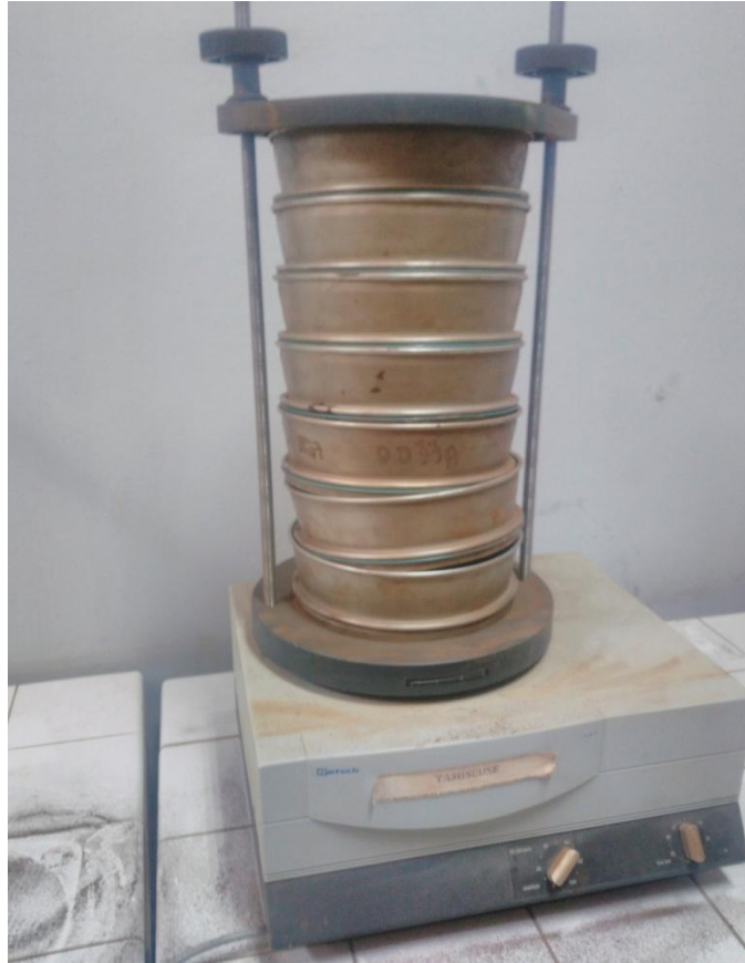
Figure 4. 4 Tamiseuse électro-vibrante (LAVAMINE) Département des Mines Université Badji Mokhtar Annaba
