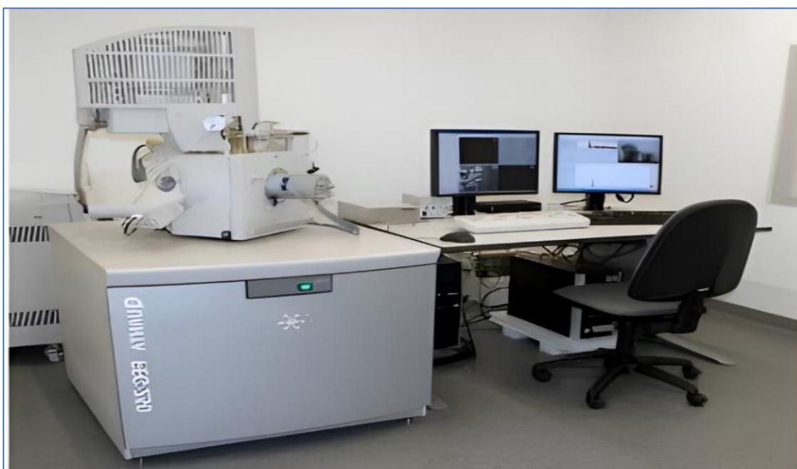
Figure II.15. Microscope électronique à balayage de modèle Quanta FEG 250.
