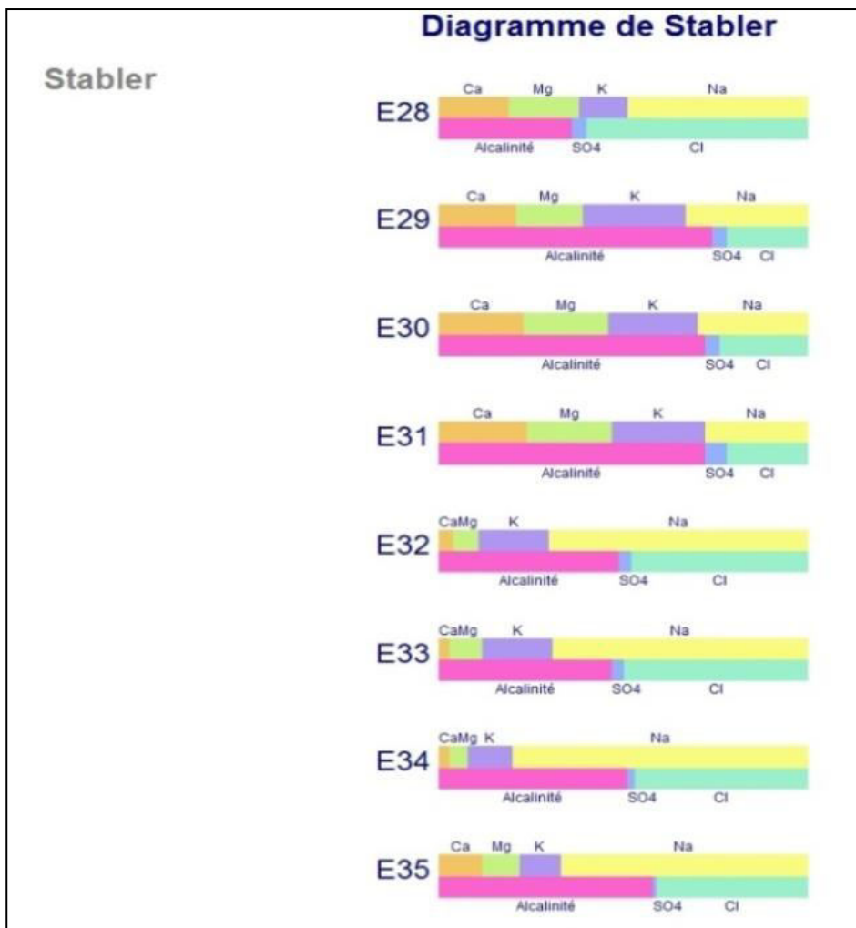
Fig. 81: Représentation graphique de faciès chimique Diagramme de Stabler (Sources thermales d'El Tarf).
