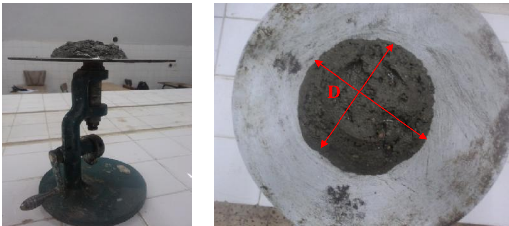
Figure II-20: Essai d'étalement à la table à secousses
