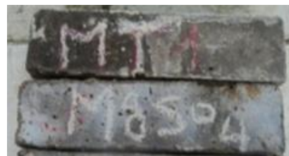
Figure IV.48- Dégradation visuelle des mortiers témoin (sans addition) conservés dans le MgSO_4
