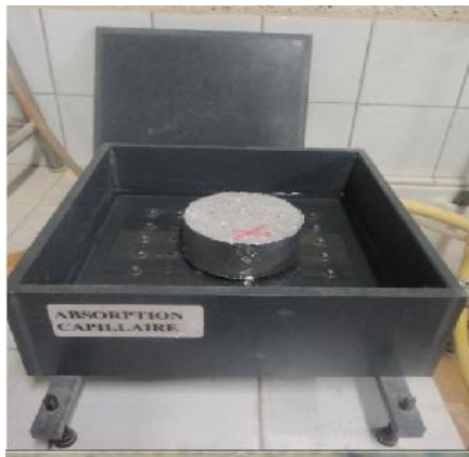
A/ Dispositif expérimental pour l'essai d'absorption capillaire
