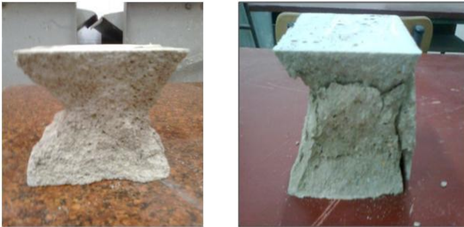
Figure III.12- Mode de rupture des bétons de sable sans fibres
