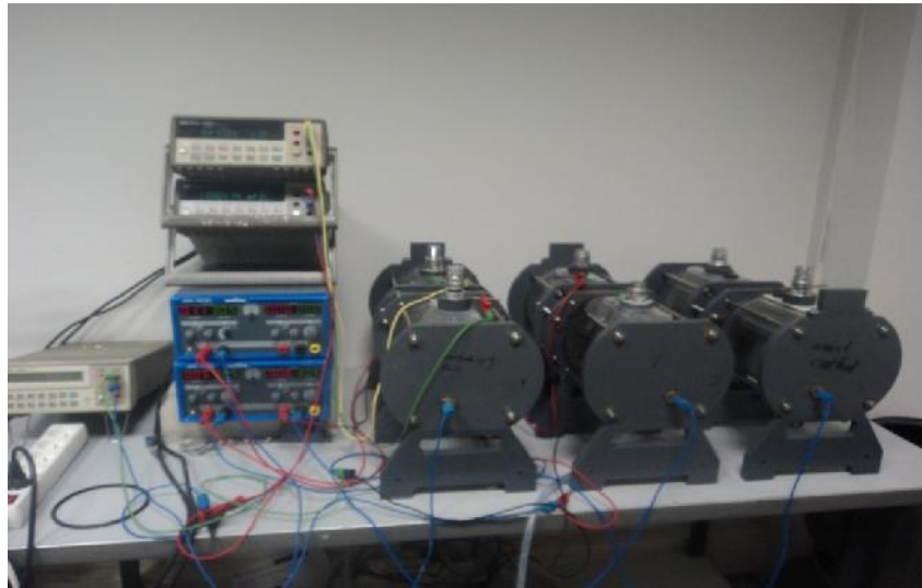
Figure IV.10-Dispositif expérimental pour l'essai de migration des ions chlorure
