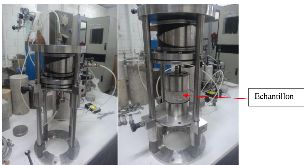
Figure IV.7- Schéma du dispositif expérimental pour l'essai de la perméabilité au gaz
