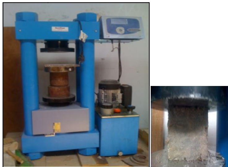
Figure III.1- Description d'essai de compression
