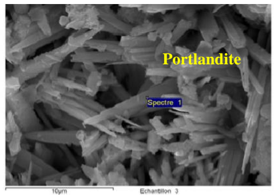
Figure IV.64-Mortier à base de fillers de laitier cristallisé conservé dans MgSO_4 après cure de 28 jours dans l'eau /couche extérieur
