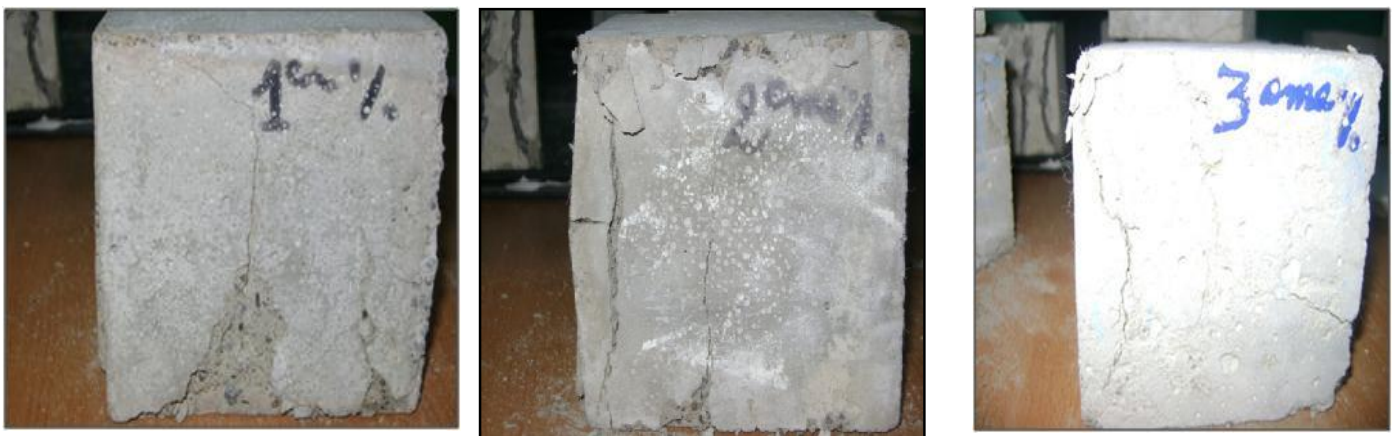
Figure III.13- Modes de rupture des bétons de sable fibré
