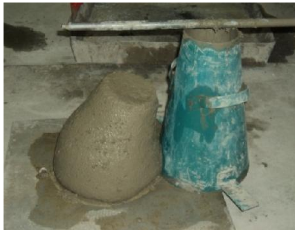
Figure II-19: Essai d'affaissement cône d'Abrams
