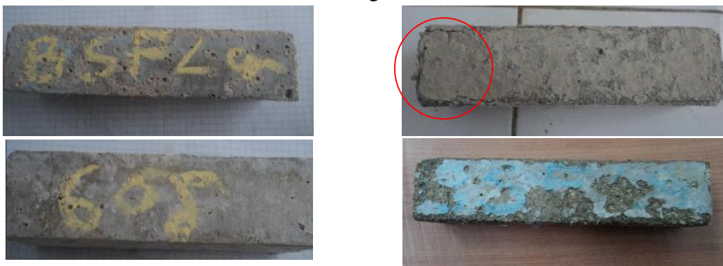
Figure IV.51- Dégradation visuelle des bétons de sable à base avec fillers calcaire conservés dans le MgSO_4
