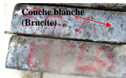
Figure IV.49- Dégradation visuelle des mortiers à base de laitier granulé conservés dans le MgSO_4
