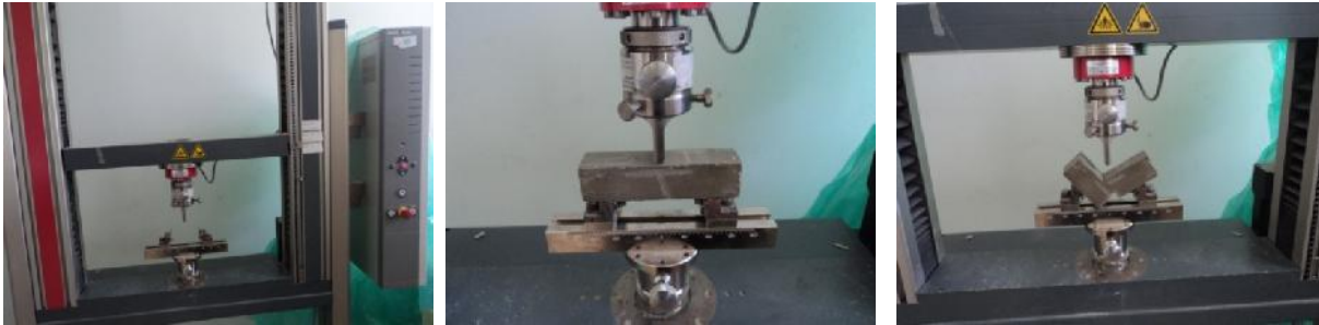
Figure III.2- Description d'essai de traction par flexion
