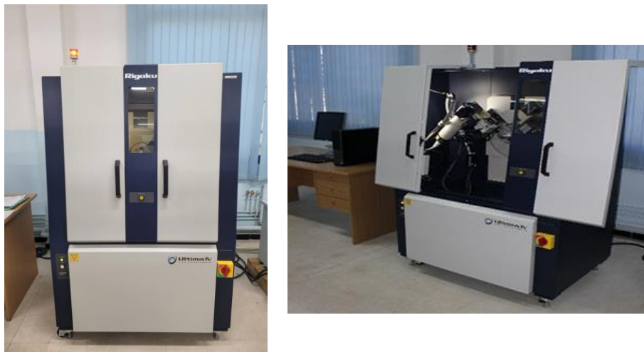
Figure IV.14 : Appareil utilisé pour la mesure DRX. (Rigaku-Ultima IV) (Unité de recherche sur les matériaux avancés. Centre de recherche sur les industries technologiques (CRTI). Annaba)
