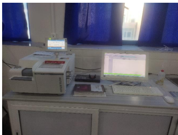
Figure IV.17: Analyseur thermique simultané (ATG / DSC) (Ecole Nationale Polytechnique. Constantine)
