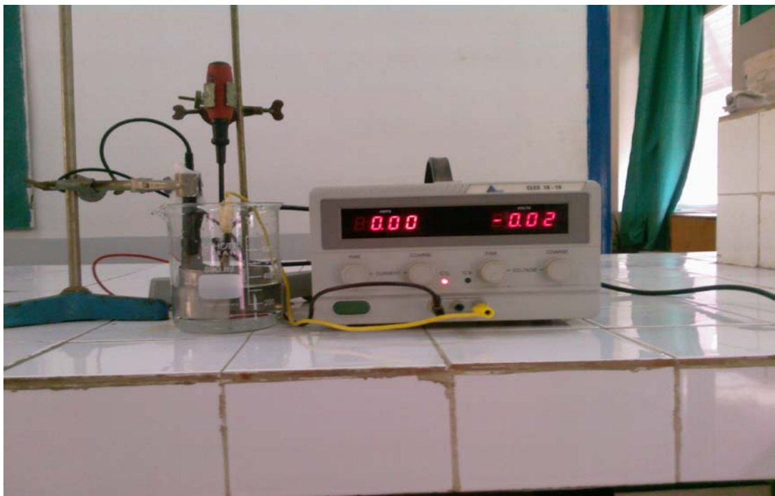
Figures II.3: Dispositif mis en œuvre pour la dissolution de la matrice :alimentation en courant continu Power-Supply Cles 18-10. Département de métallurgie(U. Annaba)
