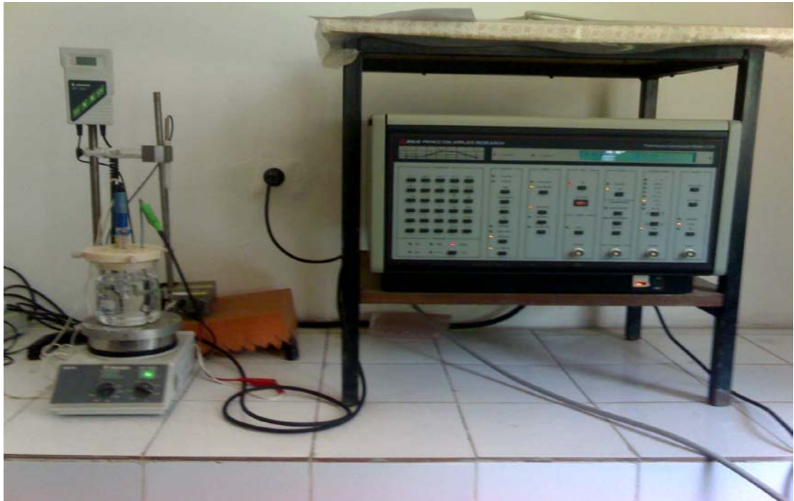
Figures II.2: Dispositif mis en œuvre pour déterminer la valeur du potentiel de corrosion de nos échantillons( Potentiostat EGG ,273A).Département de métallurgie(U. Annaba)
