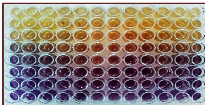
Figure III.29: Résultats du test piégeage du radical OH sur microplaque.
