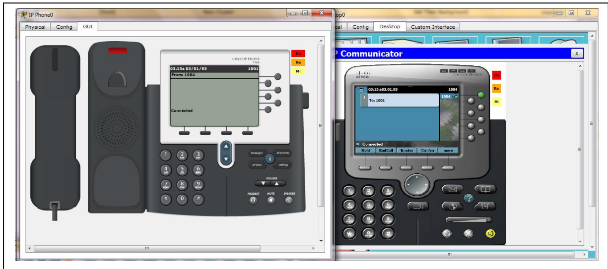
Figure III.6 : Test d'appel téléphonique entre téléphones IP 0 et IP communicator dans site 1.
