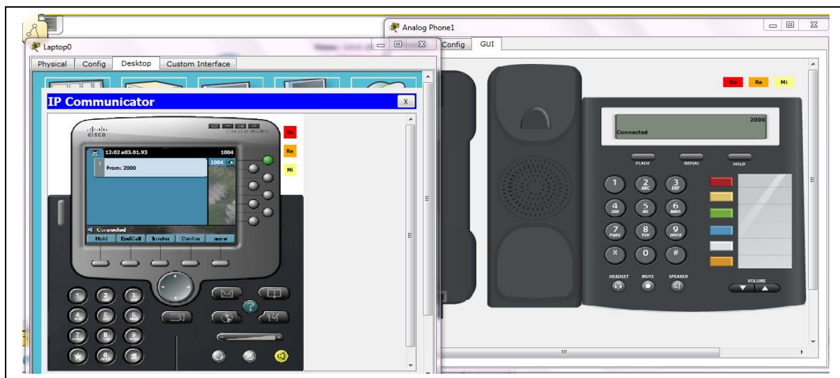
Figure III.8 : Test d'appel téléphonique entre IP communicator (Laptop0) et Analog Phone1.
