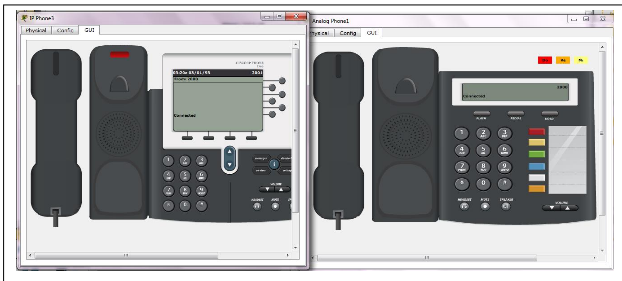
Figure III.7 : Test d'appel téléphonique entre téléphones IP 3 et Analog Phone1 dans site 2.
