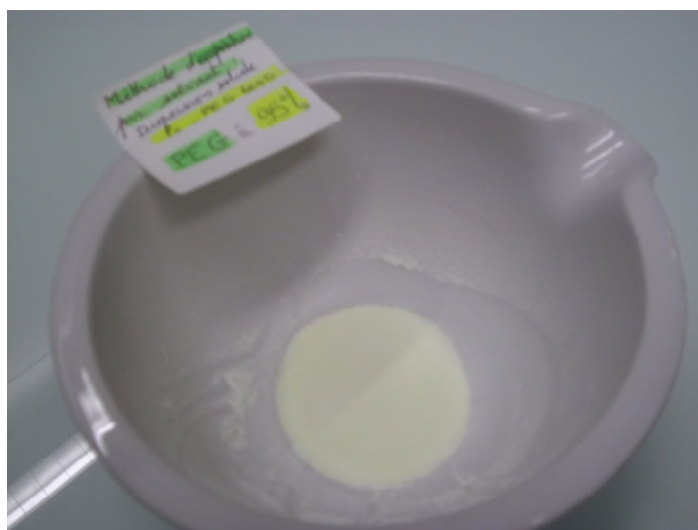
Illustration des échantillons de dispersions solides binaires (Px - PEG 6000) à 70%, 90% et 95% préparées par évaporation
