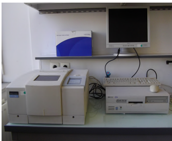
Figure 13 : Spectromètre Infra Rouge à Transformée de Fourier (IR-TF)
