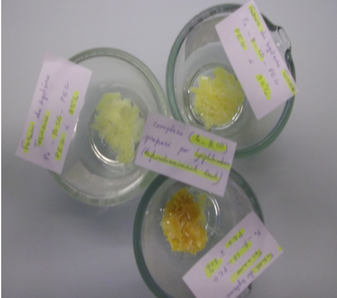
Illustrations des échantillons de dispersions solides ternaires (Px - \beta CD - PEG 6000) à 70%, 90% et 95% préparées par fusion - solidification (Refroidissement à température ambiante)
