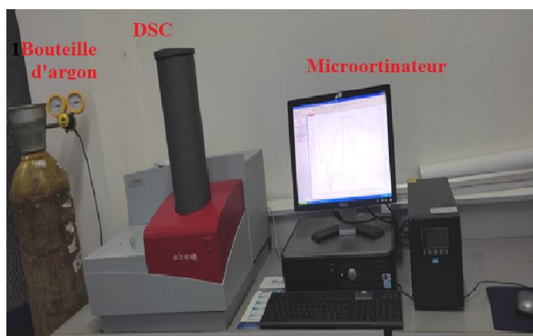
Figure II. 2: Dispositif de mesure de calorimétrie différentielle à balayage utilisé "DSC131 Evo".
