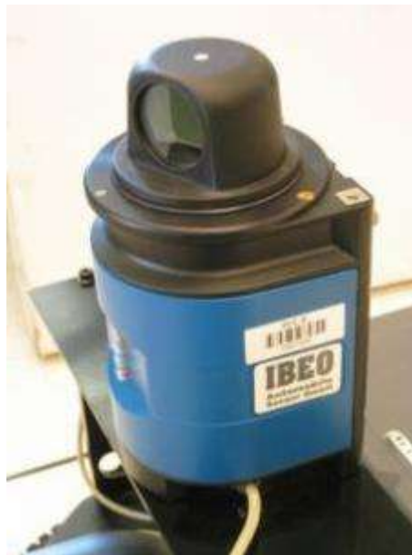
Figure 18: Un exemple d'un capteur Laser à balayage, fournit 720 mesures réparties sur 360°, à 5 Hz (marque Ibeo) (tirée de [53]).
