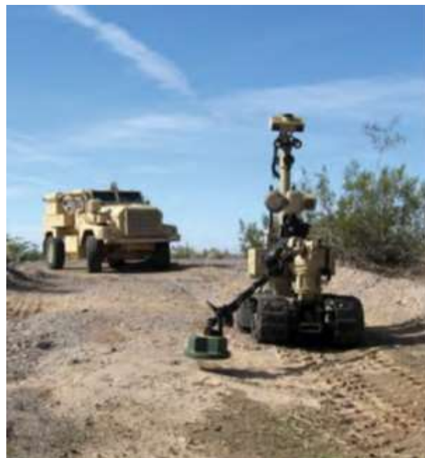
Figure 7: Système automatique de détection des bombes (AMDS: The Automated Mine Detection System), développé par Carnegie Robotics, LLC. (Image tirée de [52]).
